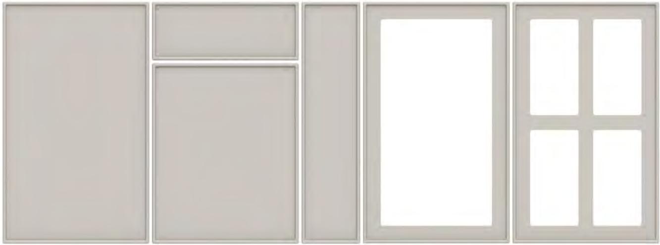
SECȚIUNE - R6: Prelucrare pe contur cu raza de 6 mm
